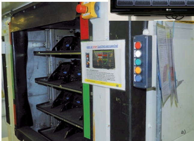
Pri výrobných strojoch sa nachádzajú tlačidlá (a), ktorými obsluha dokáže okamžite informovať údržbu o vzniknutom probléme. Stav zákazky sa v rovnakom čase zobrazí aj na veľkej informačnej obrazovke ako zelené pole (b).
