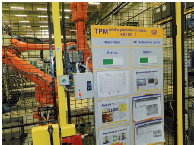
Mnohé výrobné pracoviská sú osadené informačnými tabuľkami totálne produktívnej údržby s presne definovanými postupmi.
